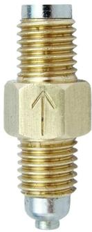
O HPJB é muito utilizado em centros de usinagem, tornos CNC, frezas e máquinas operatrizes em geral, esse dosador é ideal para pequenos sistemas de lubrificação à óleo. Sua montagem é em barras distribuidoras com diversas saídas. Possui válvula de retenção, que evita o esvaziamento da linha principal durante o intervalo de lubrificação, e um filtro para prevenir a contaminação do ponto de lubrificação. A vazão e o sentido do fluxo vêm estampado em seu corpo.
