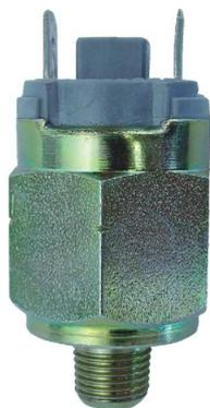
Os pressostatos são sinalizadores de pressão, com ou sem regulagem, utilizados para o controle das pressões mínima ou máxima de um sistema de lubrificação. Seu corpo é em aço com uma membrana sensível, contatos elétricos, mola interna e parafuso de regulagem de pressão que é opcional.
