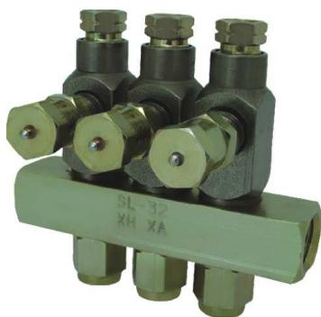
O HPIR é indicado para pequenos e médios sistemas de linha à graxa. Trabalha de forma intermitentemente através de acionamento de uma bomba manual, elétrica ou pneumática. Muito utilizado em termoformadoras, sopradoras e indústrias alimentícias em geral. É forte, robusto e trabalha em altas pressões.
