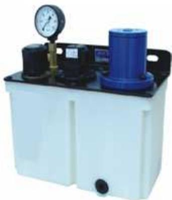
Bomba HPPO com acionamento pneumático, essa bomba é utilizada em sistemas de linha simples paralelos. É indicada para diversos tipos de equipamentos como transportadores aéreos, lubrificação de correntes em geral e máquinas operatrizes. Seu funcionamento é intermitente. Para tanto, é necessário o emprego de uma válvula 3/2 vias pneumática.
