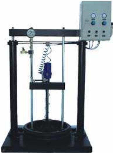
Utilizado em sistemas de dosagem precisa de graxa, esse elevador pneumático faz com que uma propulsora de graxa abasteça um sistema de dosagem com maior eficiência e confiabilidade. Ele é constituído por, um êmbolo, que auxiliado por dois cilindros pneumáticos que servem para empurrar e puxar o êmbolo, ajudando a abastecer com graxa uma propulsora, que é responsável por alimentar dosadores de graxa em linhas de montagem. Um painel de controle também compõe o produto.
