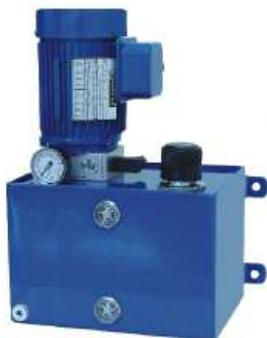
A bomba HPERM é indicada para lubrificação de máquinas operatrizes, centros de usinagem, injetoras de plásticos/alumínio e etc. Esta bomba é composta por bomba de engrenagens, reservatório em chapa de aço com pintura a pó, manômetro, visor de nível, chave de nível e bocal de enchimento com filtro.
