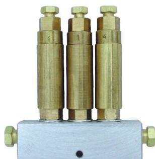
O distribuidor HPDS é amplamente utilizados em pequenos e médios sistemas à óleo na indústria em geral. É aplicado em injetoras de plásticos ou alumínio, correntes transportadoras, máquinas operatrizes e centros de usinagem em geral. Trabalha de forma intermitente. O acionamento pode ser feito através de bomba manual, pneumática ou elétrica.
