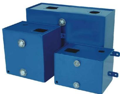
Utilizado nas bombas modelo HPERP, este reservatório é fabricado em chapa de aço com pintura a pó, material muito resistente, é indicado para lugares sujeitos a impactos ou temperaturas elevadas de óleo. Possui visor de nível, chave de nível elétrica e bocal de abastecimento com filtro.
