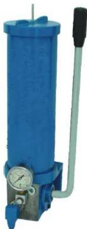
Essa unidade de acionamento manual é ideal para serviços em pequenos e médios sistemas de linha dupla paralelo. Ela pode fornecer lubrificante em condições extremas de pressão e sujeira. Robusta e confiável possui depósito em aço com haste indicadora de nível, válvula inversora de linha incorporada e manômetro.
